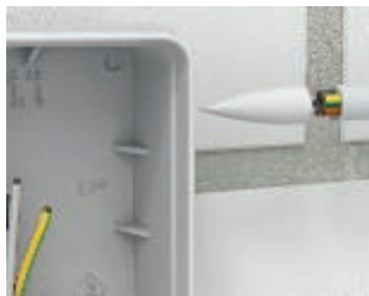
Toepassing doorsteekdoorn De doorsteekdoorn op het uiteinde van de ader steken. De kabel dan met de punt door de voorgeperste invoer drukken.
