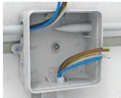
Kabelinvoer A-serie De voorgeperste kabeldoorvoeren kunnen met een mes worden geopend of met behulp van de meegeleverde doorsteekdoorn direct met de kabel worden doorstoten.
