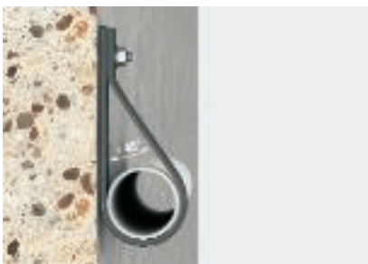
Belastingssituatie 7: buis of vergelijkbaar met band aan de wand bevestigd Minimale breukbelasting volgens kolom 2xB
