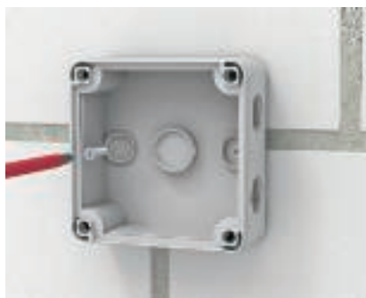
Bevestiging van de B 9/T De bevestigingsgaten in de bodem zijn voorzien van een membraan waarmee de bevestigingschroef wordt gefixeerd en de beschermingsgraad behouden wordt.
