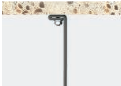
Belastingssituatie 5: met schroef aan plafond geschroefd, bandeinde dubbel geplooid, vrij bandeinde naar onder Minimale breukbelasting volgens kolom B
