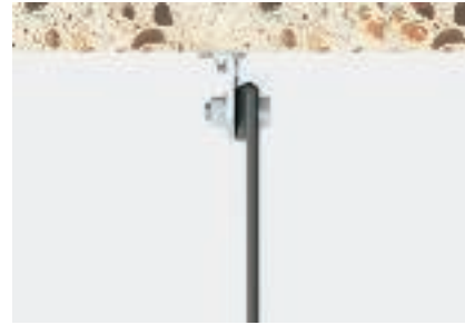
Belastingssituatie 3: op vlakke ophanger geschroefd, bandeinde dubbel geplooid, vrij bandeinde aan binnenzijde Minimale breukbelasting volgens kolom A
