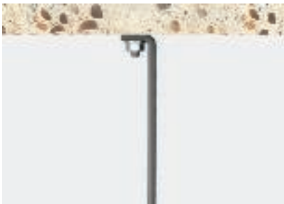
Belastingssituatie 4: met schroef en sluitring aan plafond geschroefd Minimale breukbelasting volgens kolom C
