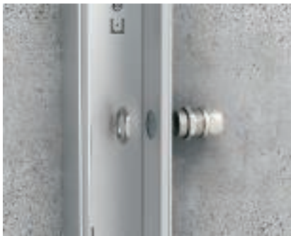
Montage messing wartel De benodigde openingen worden in de zijwand van de LKM geboord. Aansluitend de wartels door de opening schuiven en langs de binnenzijde met een borgmoer vastzetten.
